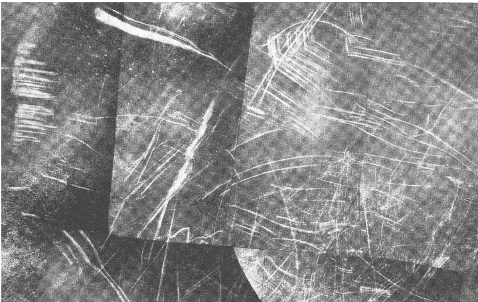
Изображение борозд выпахивания на экране корабельного гидролокатора бокового обзора
