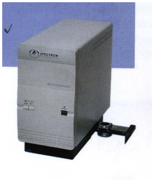
Рисунок 2.3 – Портативный рентгенофлуоресцентный сканирующий спектрометр «Спектроскан МАКС-G»
