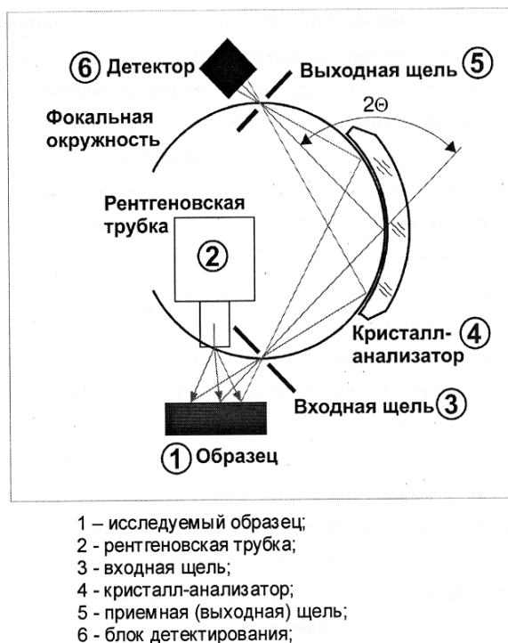
Рисунок 2.4 – Схема принципа действия прибора «Спектроскан МАКС-G»
